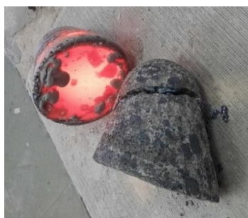
Рисунок 23 – Слиток кремния плавки №13 со шлаком после изложницы
