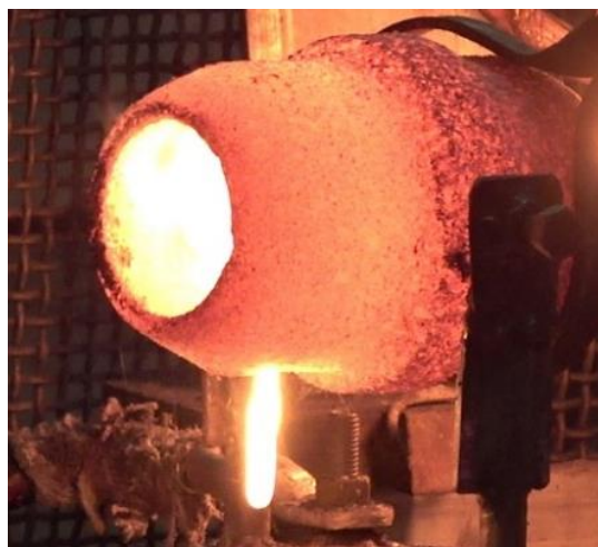
Рисунок 11 - Разливка кремния с применением устройства для прожига леточного отверстия
