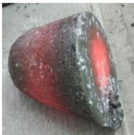
Рисунок 25 – Слиток кремния плавки №25 со шлаком после изложницы
